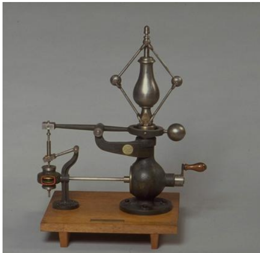
Modèle réduit de régulateur à boules vers 1880, MHNL
